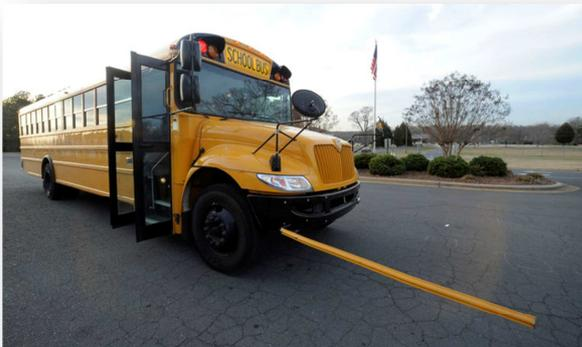
**Un bras d'arrêt pivotant** est un dispositif de sécurité en plastique qui se déploie du pare-choc avant situé sur le côté droit du car lorsqu'il est arrêté. Ce système oblige les enfants qui doivent traverser la chaussée, à se tenir plusieurs mètres devant le car, avant de pouvoir commencer à traverser. Cela garantit que le conducteur du car peut les voir lorsqu'ils traversent, en évitant ainsi un angle mort devant le bus.
