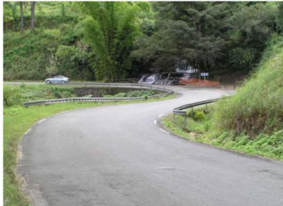
*Exemple de section présentant une sinuosité importante et des équipements de sécurité en mauvais état, ici sur la RT3 (photo DITTT).*
